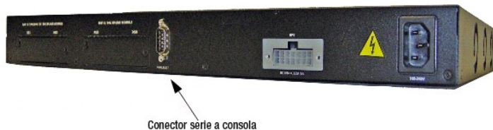
Ilustración 4-5. Conexión serie al conmutador
